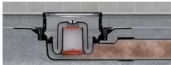
La válvula impide que los malos olores lleguen al baño, incluso aunque falle el sello hidráulico. A válvula impede que os maus odores cheguem à casa de banho, mesmo que falhe o selo hidráulico.
